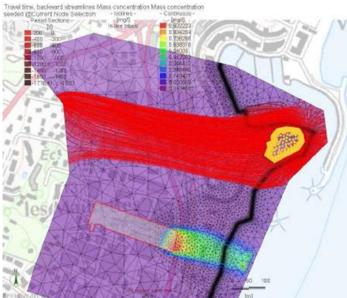
Figure 81 - Simulation du panache de pollution lors du pompage – champ d'alimentation du pompage de la fouille
