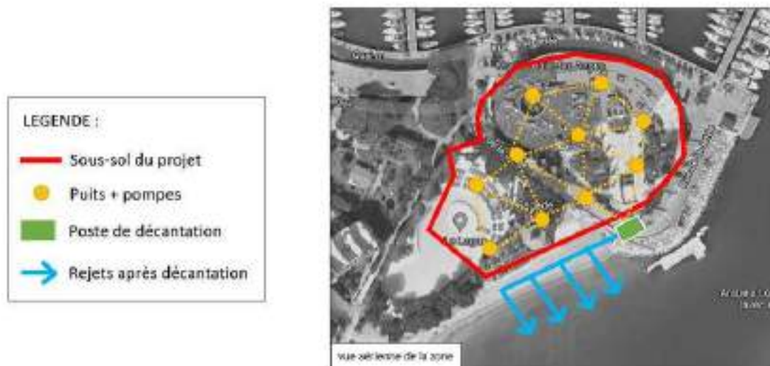
Figure 30 - Méthodologie du rabattement de nappe
